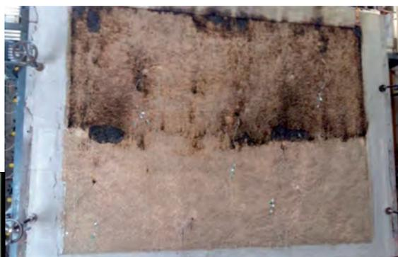
Face non exposée au feu en fin d'essai (température moyenne de surface < à 75 °C - valeur limite : 140 °C).
