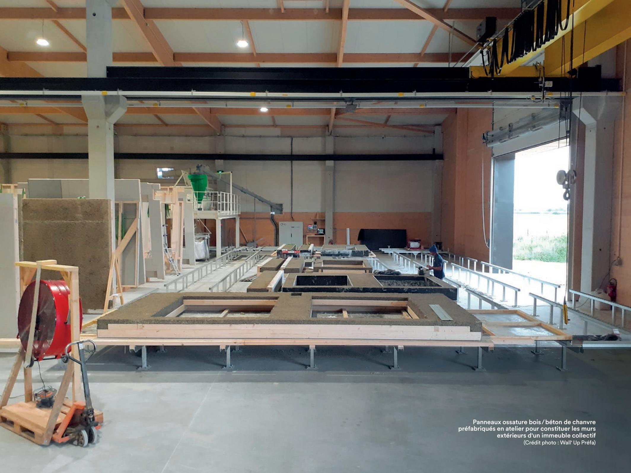
Panneaux ossature bois/béton de chanvre
